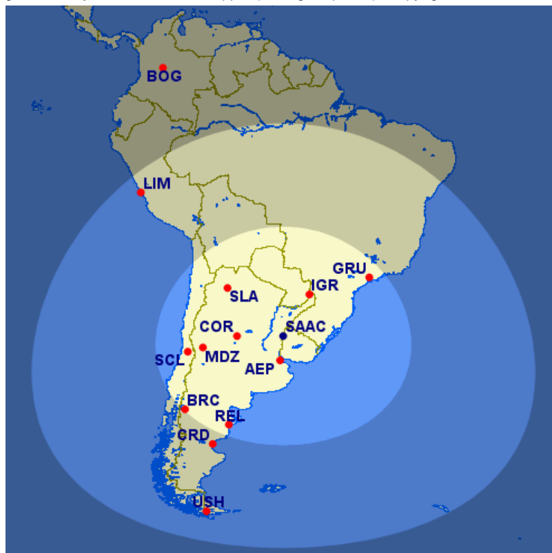
Figura 7 – Alcance B738 para pista de 2000 metros. Fuente: elaboración propia a partir de manuales de fabricantes. Maps generated by the Great Circle Mapper ( www.gcmapper.com ) - copyright © Karl L. Swartz
